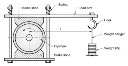
Fig. 5. 3 Prony Brake Dynamometer
