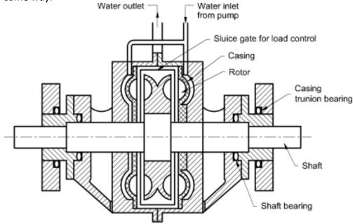
Fig. 5. 5 Hydraulic Dynamometer
