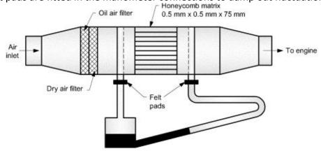
Fig. 5. 13 Alcock viscous air flow meter
