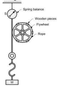
Fig. 5. 4 Rope Brake Dynamometer
