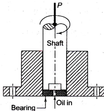
*Fig. 3.10 Footstep bearing*
