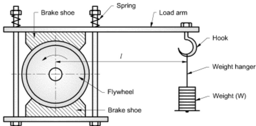
*Fig. 5. 3 Prony Brake Dynamometer*
