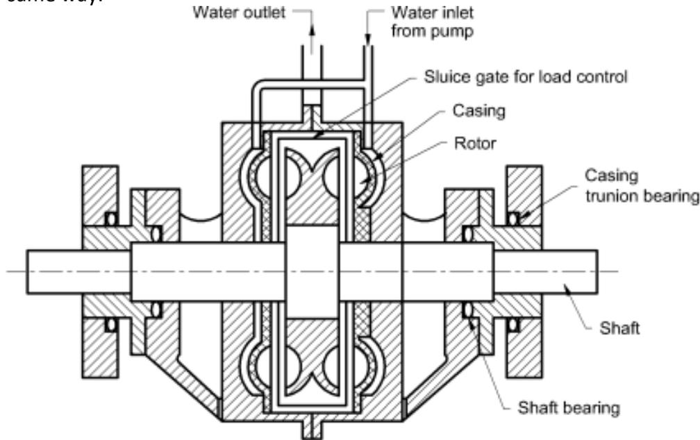
Fig. 5. 5 Hydraulic Dynamometer
