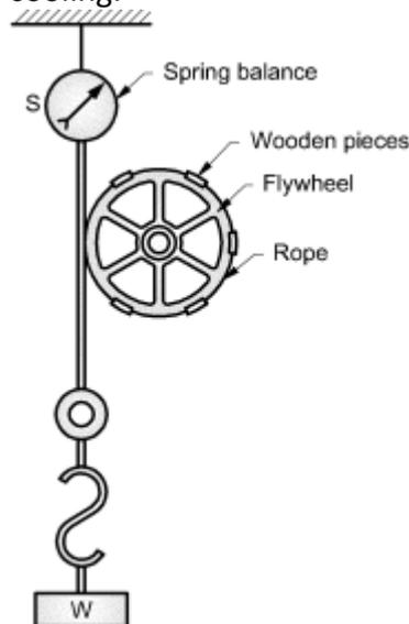
Fig. 5. 4 Rope Brake Dynamometer
